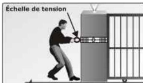
Les galets de guidage doivent garantir que la porte est maintenue verticalement sur toute la longueur de la course de la porte. Pour une sécurité accrue, un montant de support supplémentaire est installé pour empêcher que la porte ne tombe en cas de défaillance des galets de guidage.
