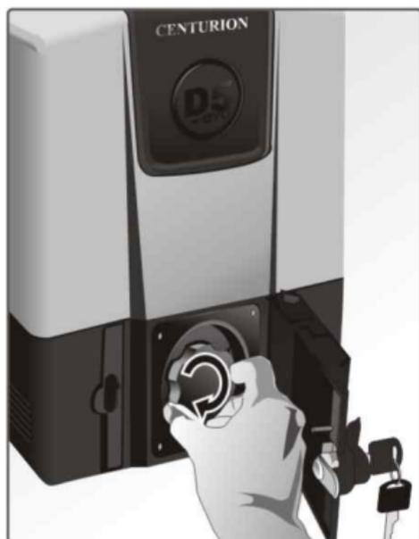
3. Si, pour une raison quelconque, la boîte à engrenages devait être laissée en mode manuel pendant une longue durée, il est recommandé de verrouiller la trappe d'accès. Cela maintient le couvercle et empêche tout accès à l'intérieur de l'unité où résident des tensions élevées. Cela empêche également le vol de tout composant et garantit une parfaite protection contre les éléments.
